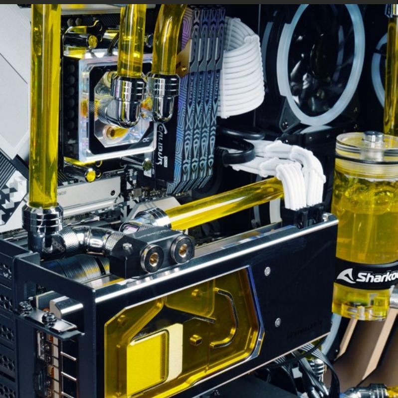
Per un utilizzo immediato sono già presenti cinque ventole preinstallate; ovviamente, l'interno dell'ELITE SHARK CA700 può anche essere raffreddato con un sistema ad acqua. In ogni caso, la peculiarità di questo case è la possibilità di installare contemporaneamente due radiatori da 360 mm, uno sulla sua parte superiore e uno accanto alla scheda madre.
